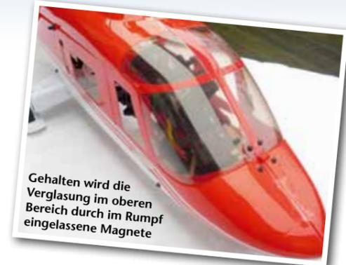
Gehalten wird die Verglasung im oberen Bereich durch im Rumpf eingelassene Magnete
