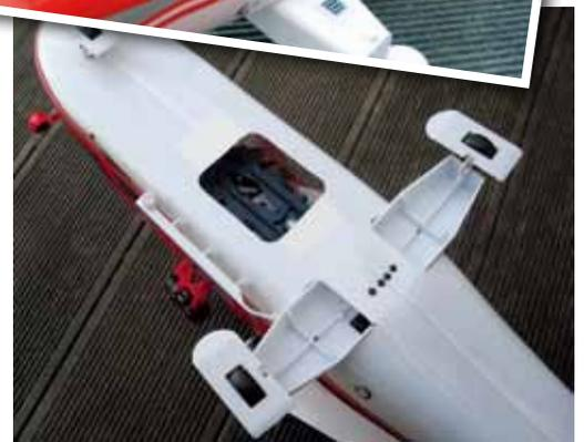
Blick auf die Unterseite mit dem an der Mechanik verschraubten Hauptfahrwerk
