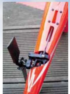
Blick auf die Unterseite des Heckbereichs auf die sauber angebrachten Ausfräsung im Bereich des Gestänges
