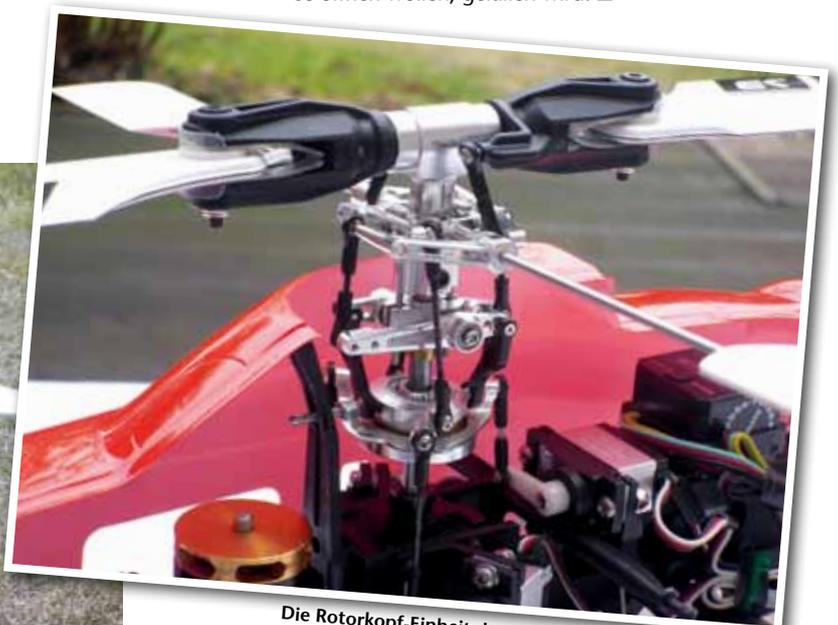
Die Rotorkopf-Einheit des mini-Titan mit untenliegender Stabstange ist hauptsächlich aus Metall gefertigt und verleiht der Agusta ein präzises Flugverhalten
