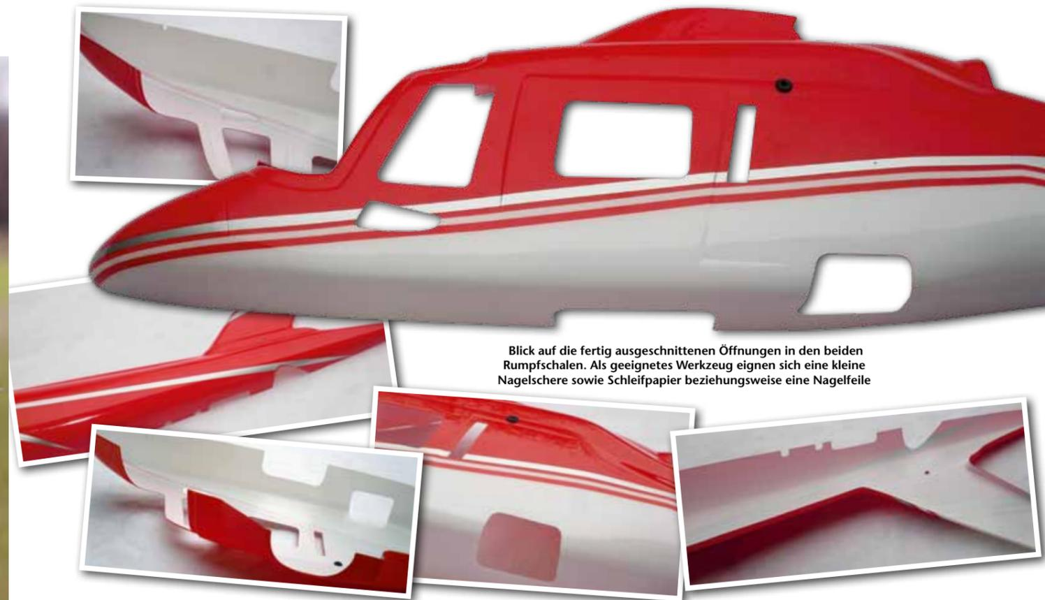
Blick auf die fertig ausgeschnittenen Öffnungen in den beiden Rumpfschalen. Als geeignetes Werkzeug eignen sich eine kleine Nagelschere sowie Schleifpapier beziehungsweise eine Nagelfeile
