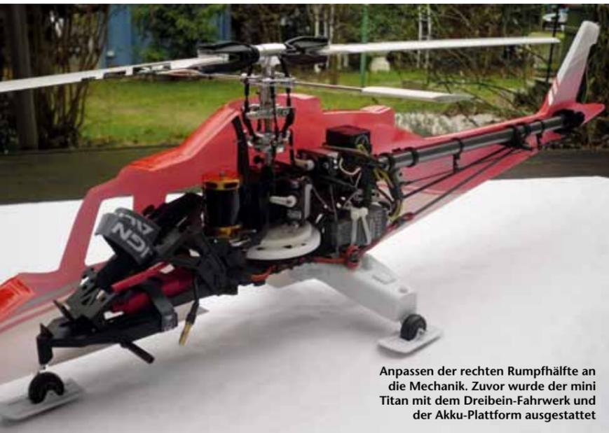
Anpassen der rechten Rumpfhälfte an die Mechanik. Zuvor wurde der mini Titan mit dem Dreibein-Fahrwerk und der Akku-Plattform ausgestattet
